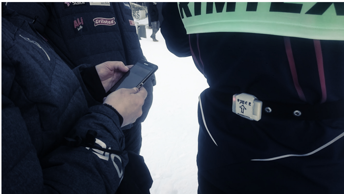
Figur 1 Data overføres via Bluetooth i sanntid fra Apertus IMU til en mobiltelefon som mottar og lagrer de innsamlede data for videre etterbehandling
