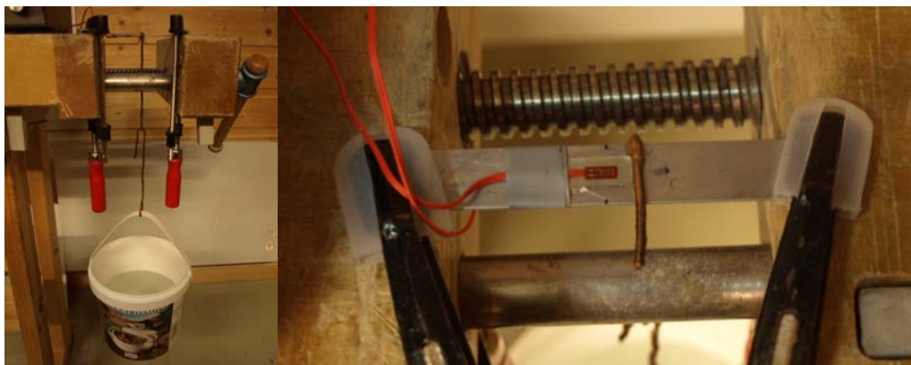
Figur 9.9 Måleoppstilling for måling av nedbøyning som funksjon av belastning.
