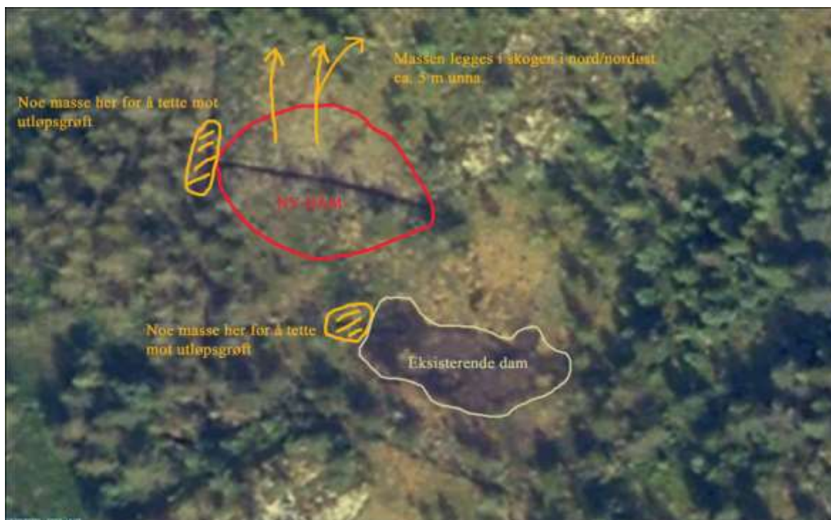
Figur 3. Nr.1. Tuvmyra N med inntegnet ny dam og masseforflytning. III.: Eva Tilseth.
