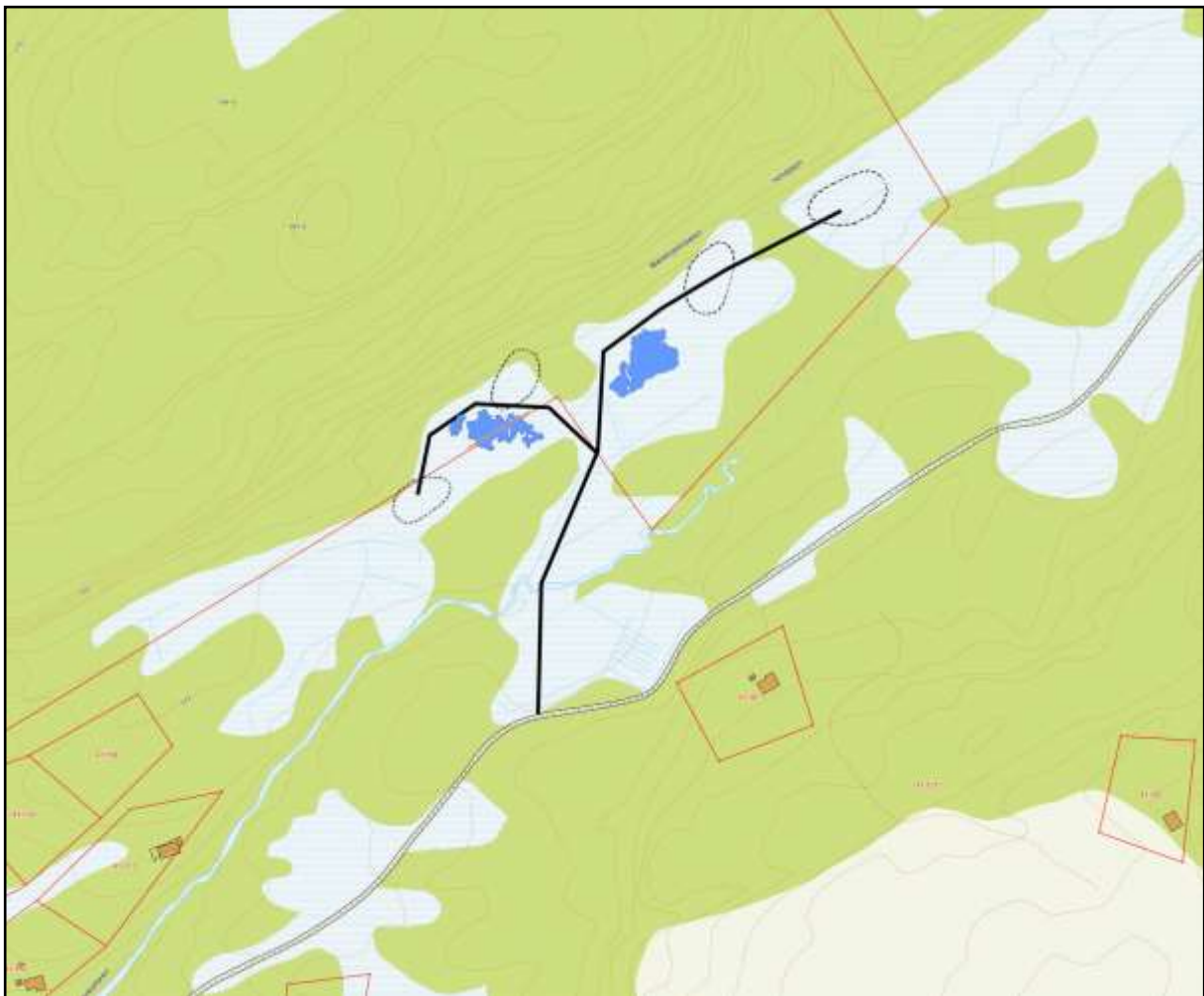
Figur 4. Forslag til trasé for gravemaskin. III. Irvin Kilde. Kartgrunnlag: NorgeDigitalt.
