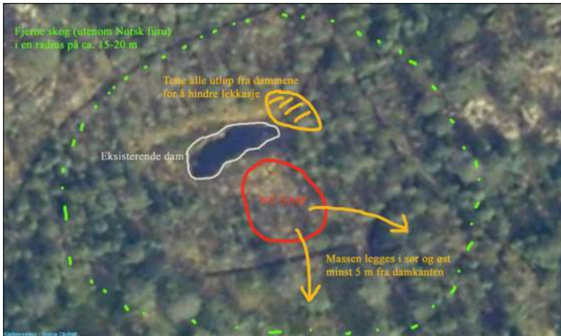
Figur 6. Lokalitet Nr. 3. N for Hestsjøberget med inntegnet ny dam, fjerning av skog og masseforflytning. Ill.: Eva Tilseth.
