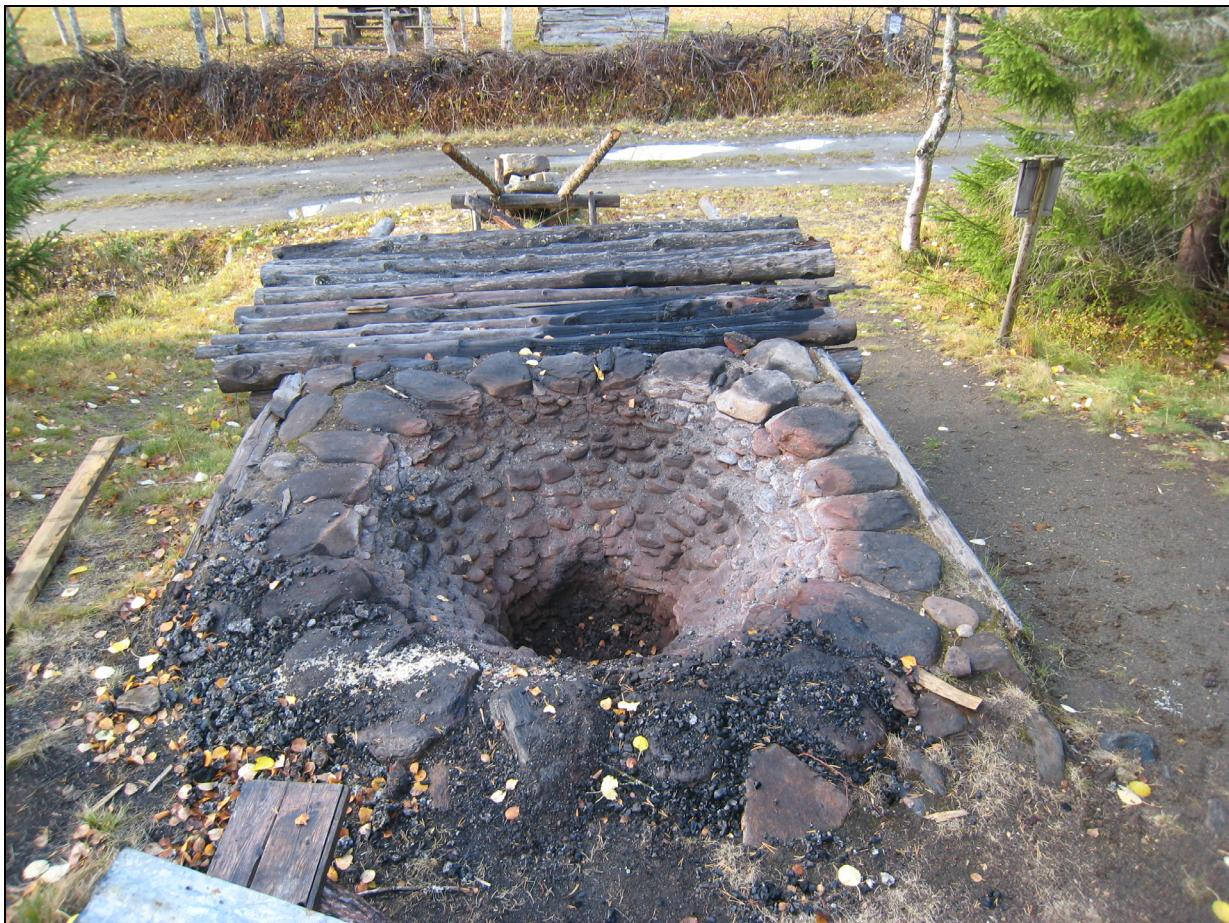
**Figur 2.2.** Rekonstruksjon av jernframstillingsovn på Storbekksetra basert på Ole Evenstads beskrivelse og tegninger fra 1780. Foto: L. F. Stenvik.
